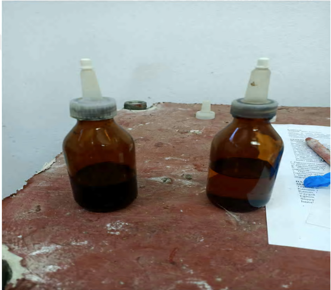
Şekil 2.3.4. Çalışmada katalizör olarak kullanılan kobalt naftanat (solda) ve radikal oluşturucu olarak kullanılan peroksit (sağda)
