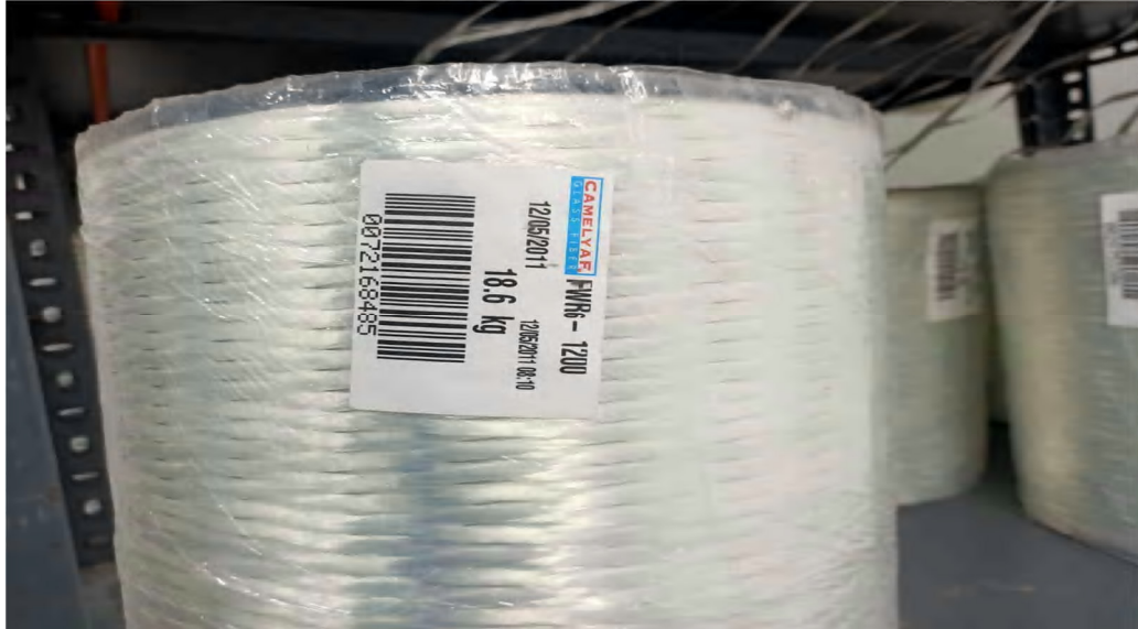
Şekil 2.2.2. Çalışmada kullanılan FWR 6 cam elyaf
