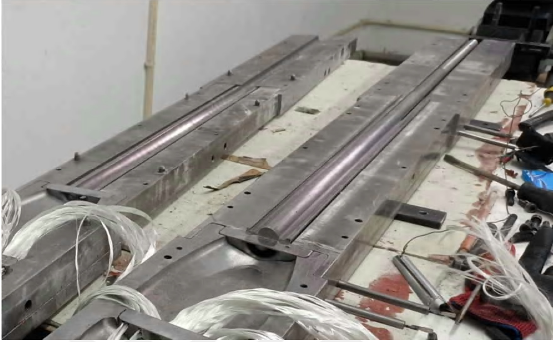
Şekil 2.1.4. Kalıbın üst-alt tabakalarının (solda üst, sağda alt) 2. ve 3. parçaları.
