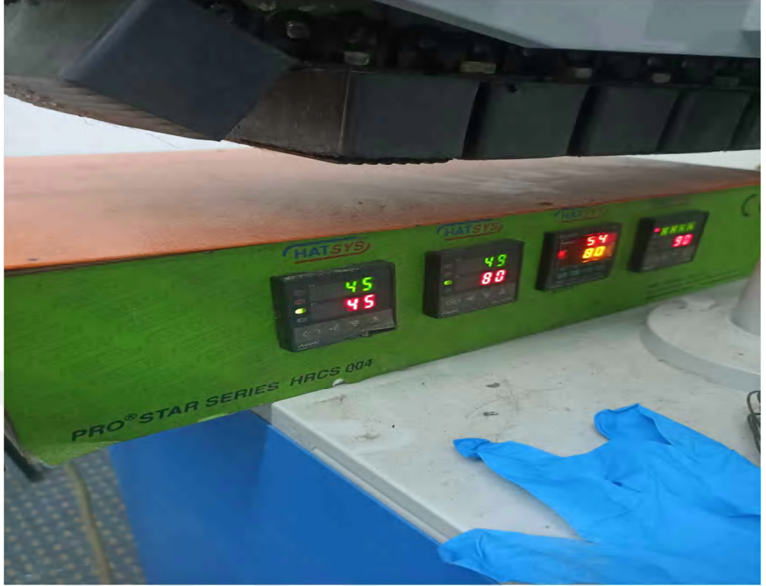
Şekil 2.4.1. Kalıplar için girilen sıcaklık değerleri (alt kısım) ve Termokupl sıcaklık değerleri (üst kısım)
