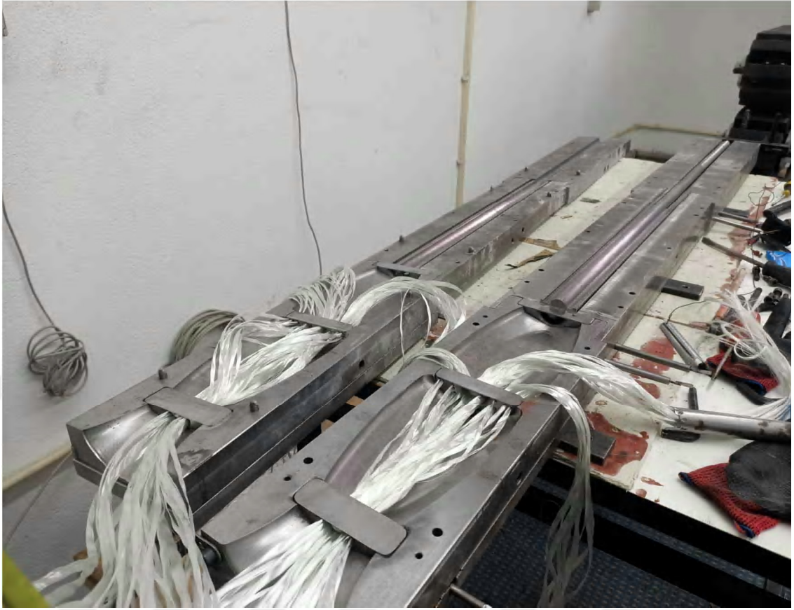
Şekil 2.2.4. Elyafaların kalıbın havuz bölümündeki deliklerden geçişi
