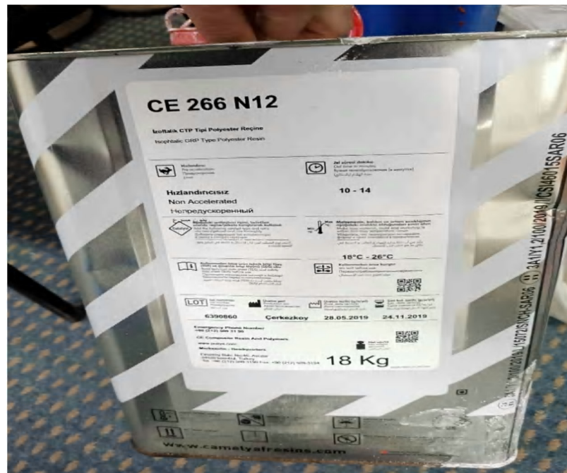
Şekil 2.3.3. Çalışmada kullanılan izofthalik stirenli reçine
