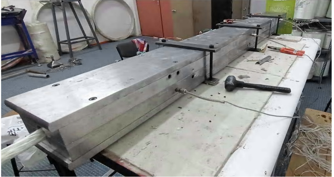
Şekil 2.4.2. Kalıplara bağlanan Termokupllar
