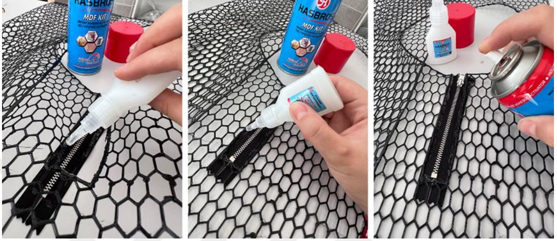
Görsel 27: Üç boyutlu alt beden giysiye (etek) fermuar yerleştirme işlemi
