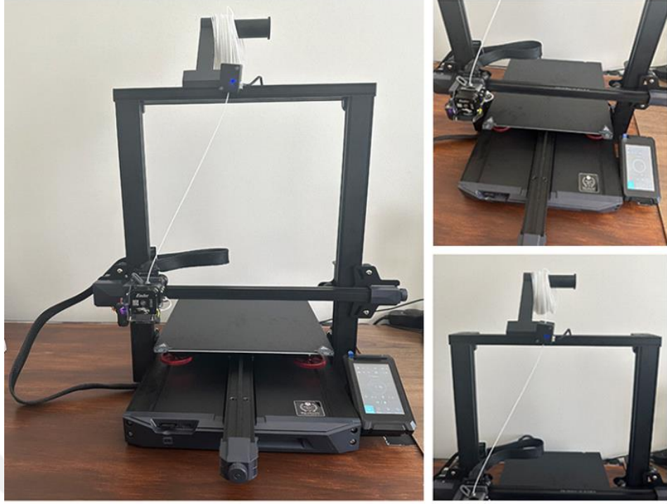
Görsel 2: Doku üretiminde kullanılan birinci FDM tipi üç boyutlu yazıcı
