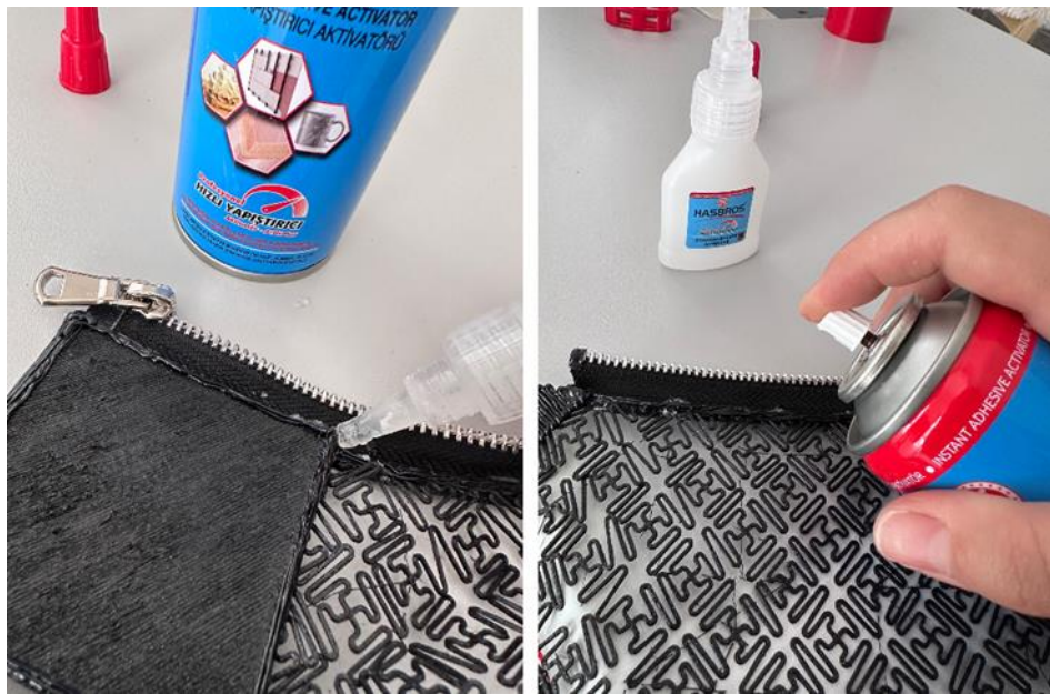
Görsel 23: Üç boyutlu alt beden giysiye (etek) fermuar yerleştirme işlemi
