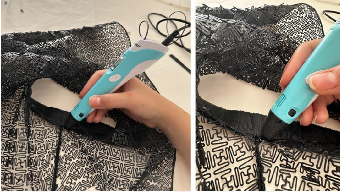
Görsel 22: Üç boyutlu üst giysiye (sweat) üç boyutlu baskı kalemi ile yan ürünlerin eklenmesi işlemi
