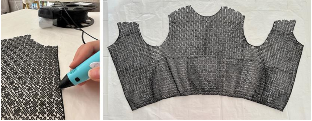
Görsel 20: Üç boyutlu üst giysiye (sweat) ait kalıbın üç boyutlu baskı kalemi ile çerçevesi
