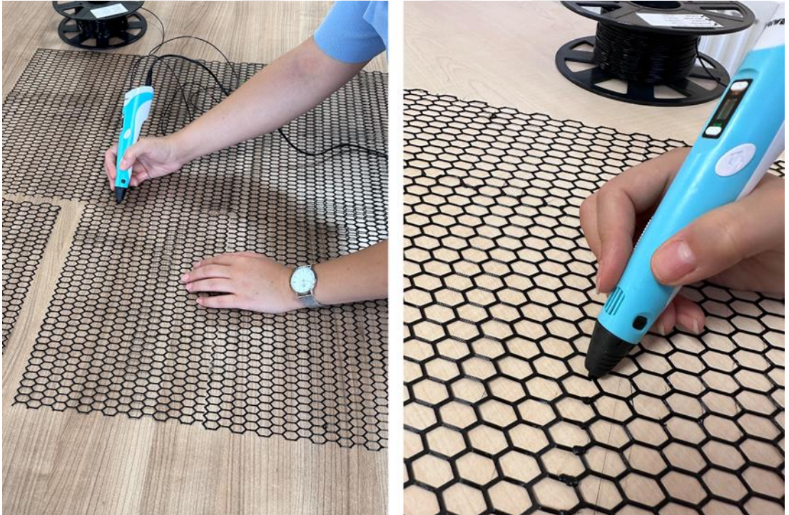
Görsel 11: Desen 1'in üç boyutlu baskı kalemi ile birleştirilmesi
