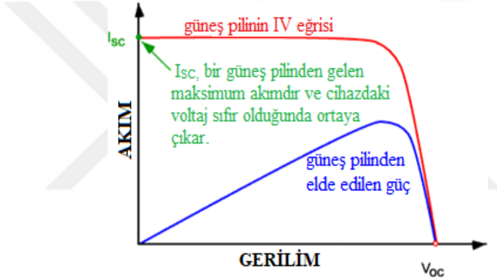
Şekil 2.5. Kısa devre akımı, güneş pili I-V karakteristiği
