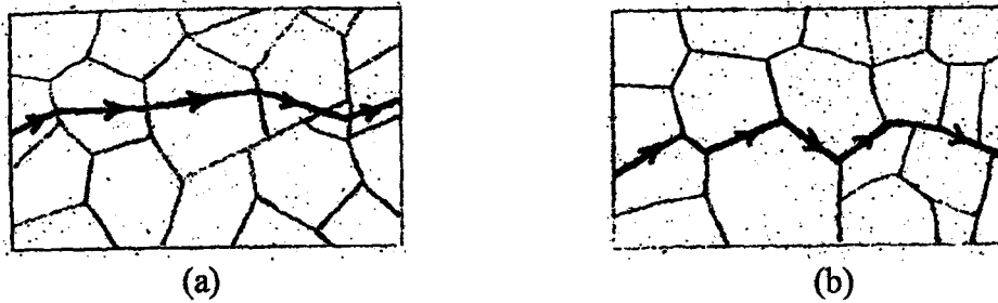
Şekil 2.2. a) Tane içi ve b) Taneler arası kırılmanın şematik olarak gösterilişi (Uğuz 1996).
