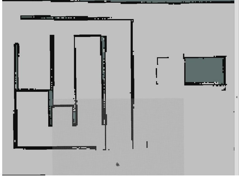
Şekil 4.4. SLAM ile oluşturulan Doluluk Izgara Haritası (Occupancy Grid Map).
