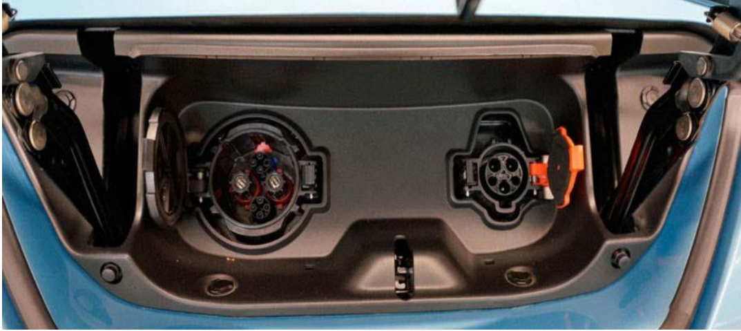
Şekil 3.7. Nissan Leaf Mod 4 CHAdeMO ve Mod 3 soketleri [15]
