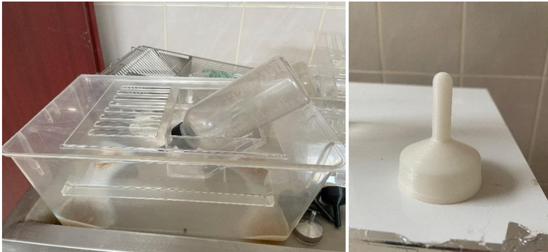
Şekil 3.2. Tasarlanan Kafes Kapakları ve Suluk Ucu
