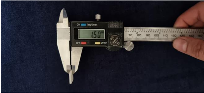
Resim 3.3. Örnek kalınlıklarının dijital kumpas ile ölçülmesi
