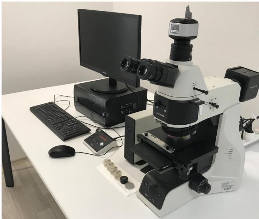
Resim 4.5. Huvitz HRM-300 optik profilometre cihazı [117]
