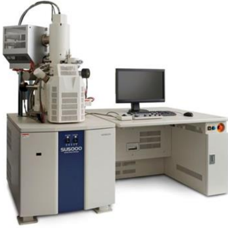
Resim 4.4. Hitachi SU5000 FE-SEM cihazı [116]
