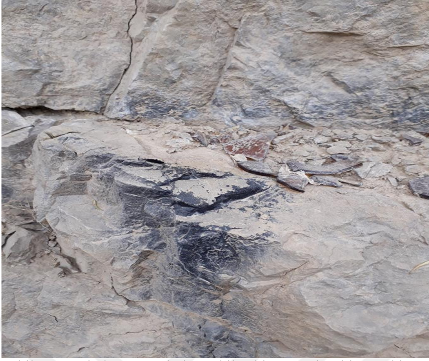
Şekil 15. Bağlarbaşı yöresinden çekilen bitüm seviyesi içeren kireçtaşı tabakasının arazi görünümü
