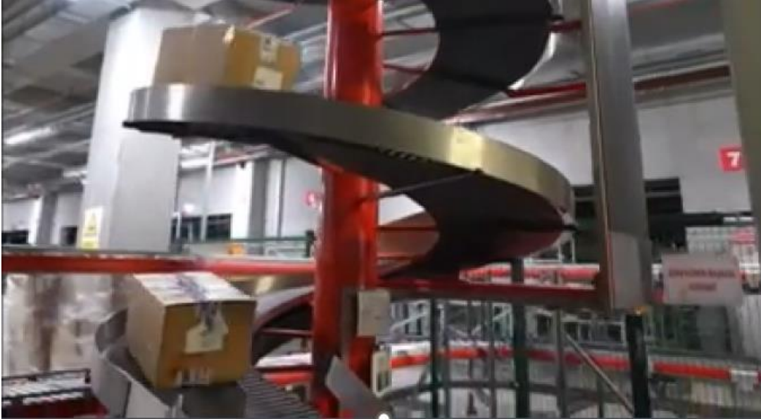
Şekil 8 Kolilerin Taşındığı Konveyör Hattı
