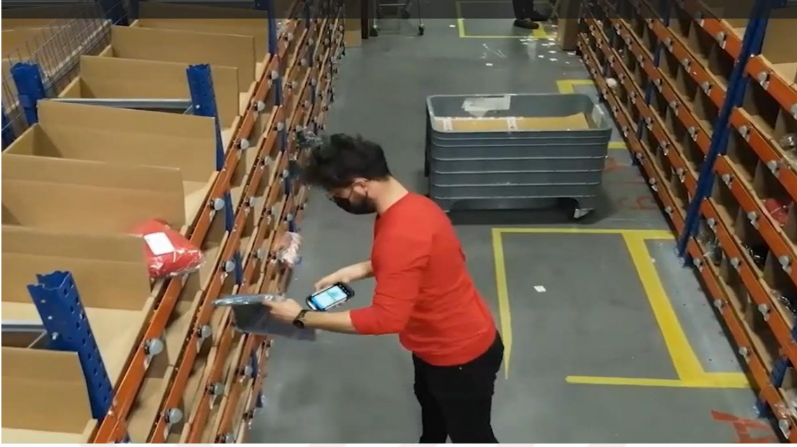
Şekil 7 El Terminalleri ile Adresleme İşleminin Yapılması
