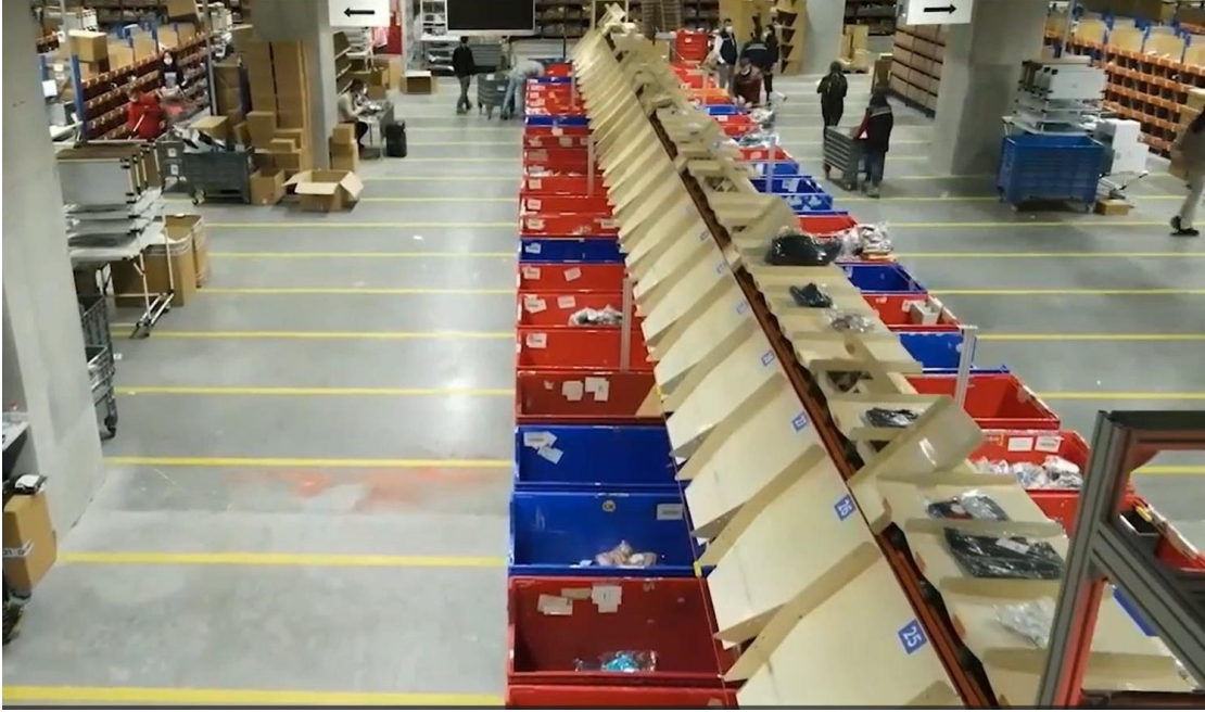
Şekil 6 Ayrıştırma İşlemi Yapan Sorter Hattı
