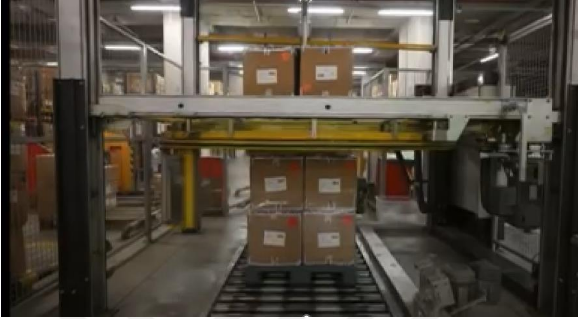
Şekil 9 Kolilerin Otonom Araç Yardımıyla Ambalajlanması
