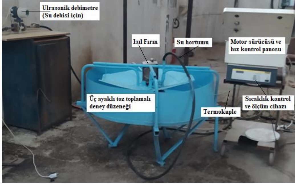
Şekil 3.31. Metal toz üretimi için deney düzeneği
