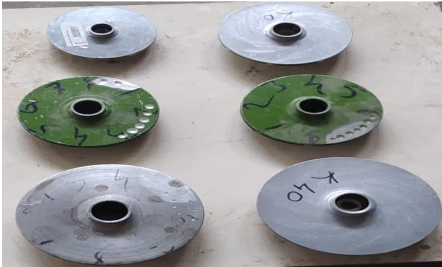
Şekil 3.25. Su püskürtülmesinde kullanılan pompa fanların resmi
