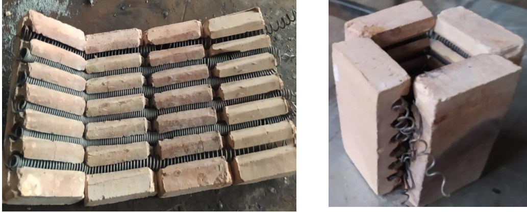
Şekil 3.5. Elektrik direnç tellerinin taş fırını kanallarına geçirme ve hacim oluşturma getirme
