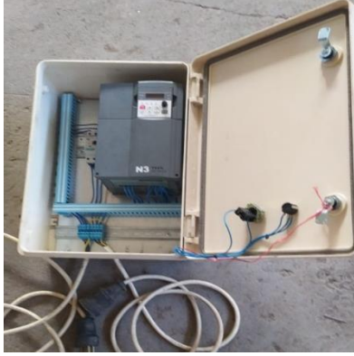
Şekil 3.20. Yüksek devirli motorun sürücüsü ve kontrol kutusu
