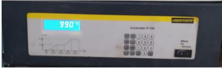
Şekil 3.34. Metal eriğin sıcaklığı ve zamanı gösteren ölçüm ve kontrol cihazı
