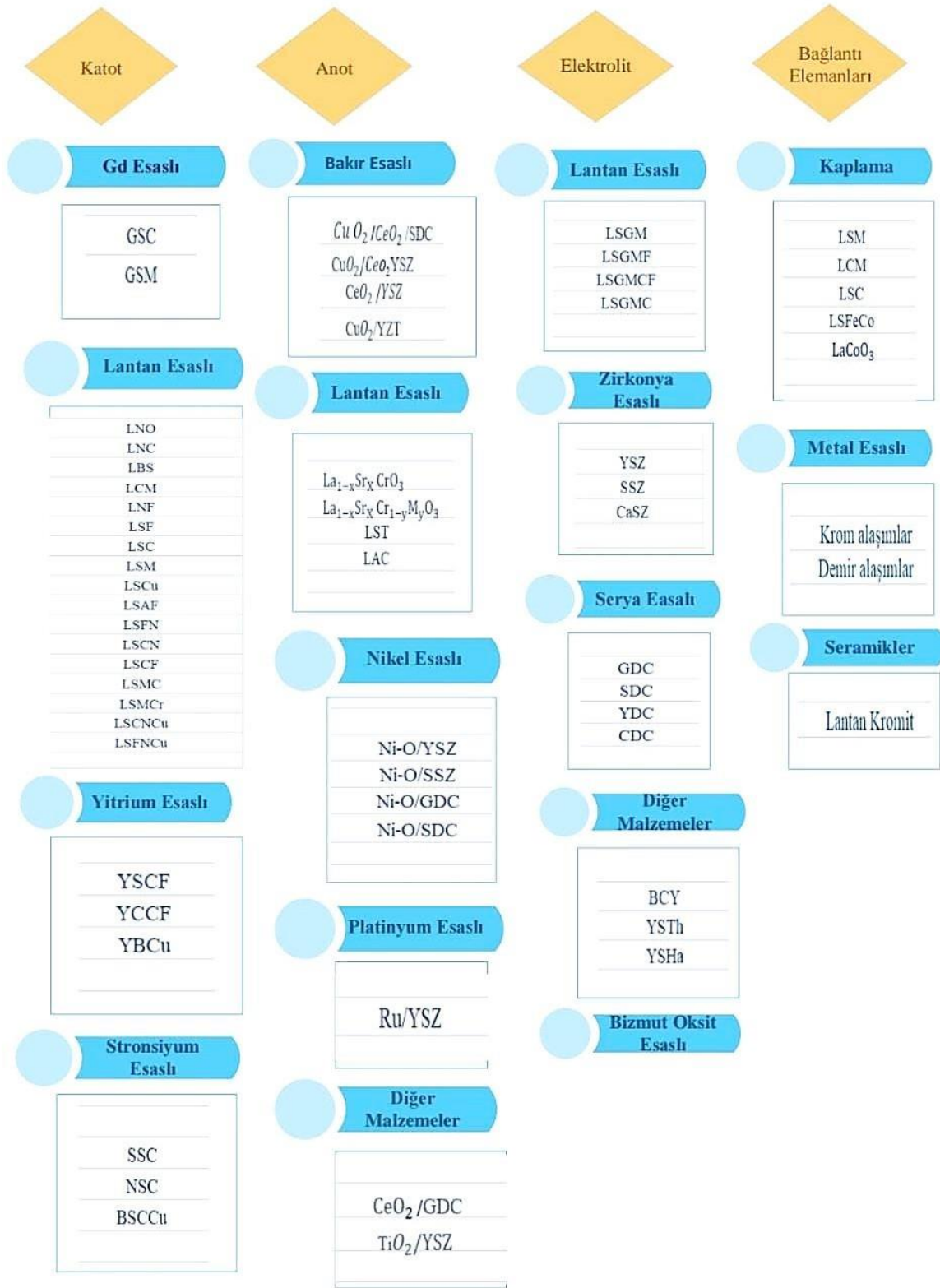
Şekil 2. 12: KOYH'lerde kullanılan malzemelerin sınıflandırılması[34].
