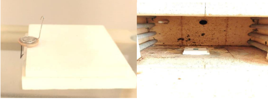
Şekil 3. 13: Pelletlerin her iki tarafına gümüş pastesi ve gümüş teller uyguladıktan sonra termal işlem uygulanmıştır.
