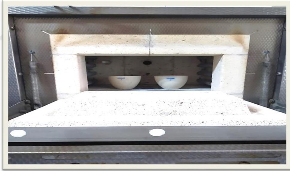
Şekil 3. 4: 700°C'de 4 saat kalsinasyon işlemine tabi tutulan numuneler
