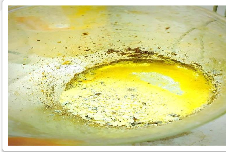
Şekil 3. 2: Jel Kıvamındaki malzemenin katı köpük hali.
