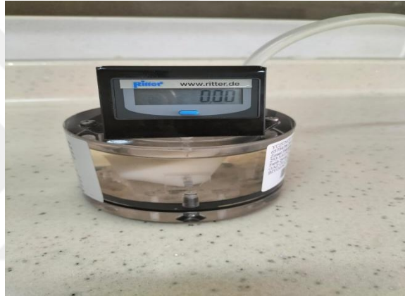
Şekil 3.12 Biyogaz ve metan ölçümünün yapıldığı gaz sayacı
