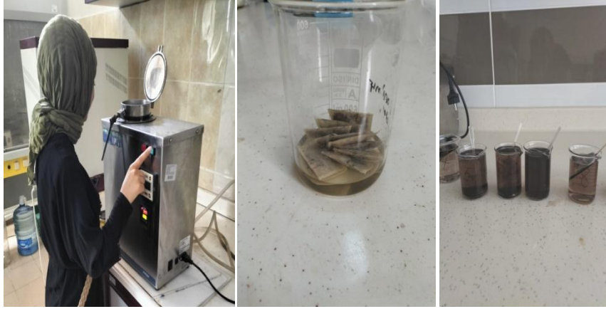
Şekil 3.9 ADF, NDF ve ADL analiz süreçleri
