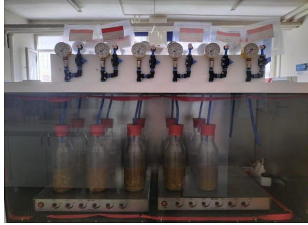
Şekil 3.7 İnkübatör ve biyoreaktör düzeneği
