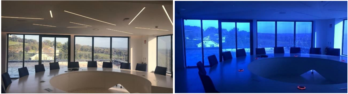
Görsel 69. Elektrokromik Cam Uygulaması. https://bit.ly/3q3wwHb
