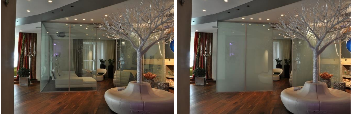
Görsel 70. Sıvı Kristal Cam Uygulaması. https://bit.ly/43nPE13
