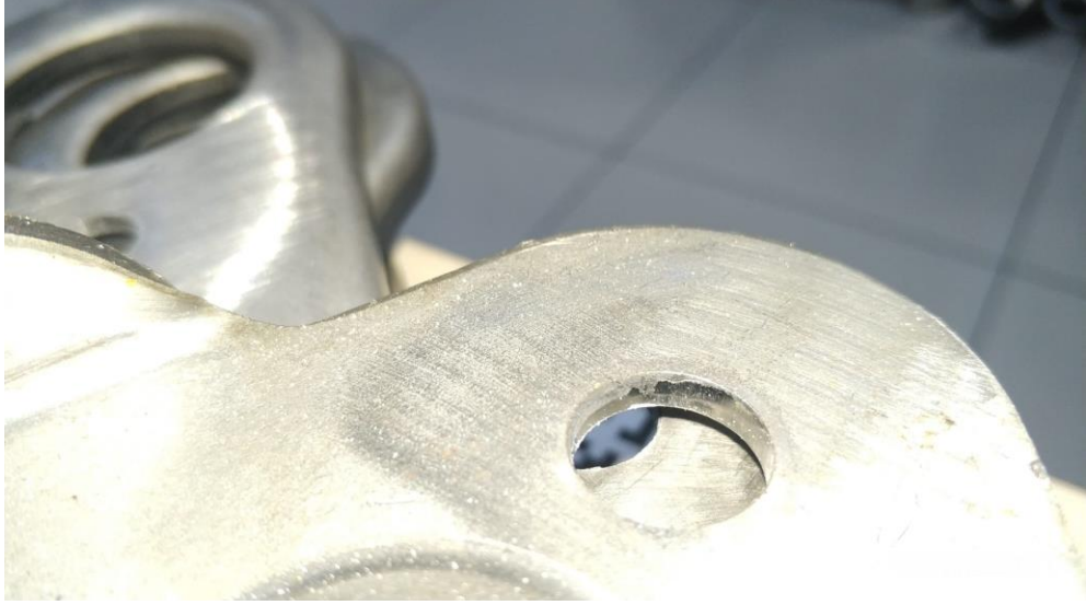
Şekil 4.4: Kesme kenarlarında oluşan temiz ve kaba yüzeyler [16].
