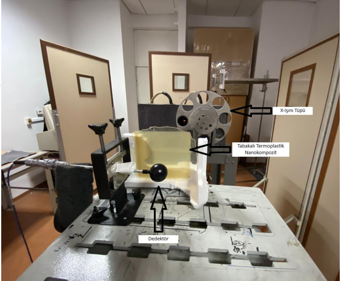
Şekil 4.13. X-Işını Azalım Testleri İçin Kurulan Düzenek
