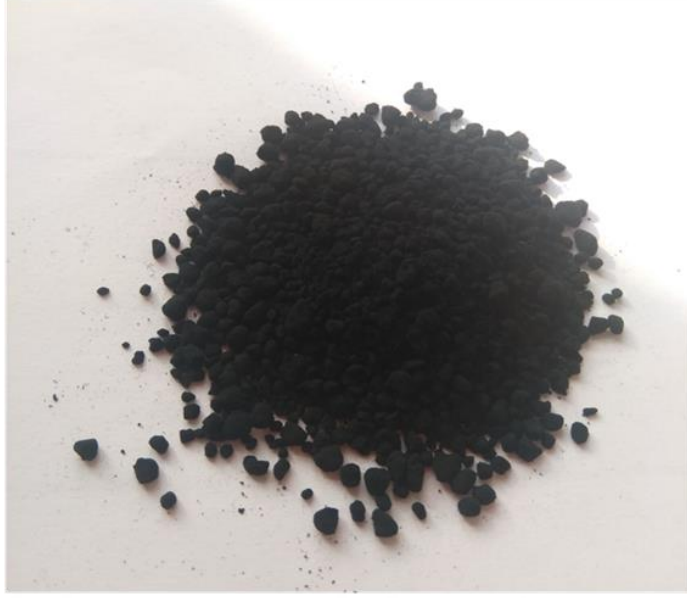
Şekil 5.3. Hazırlanan karışımlardan elde edilen granüller ( \text{SiO}_2 + \text{C} )
