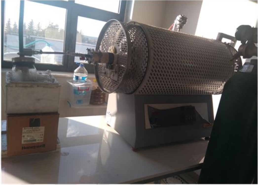
Şekil 5.4. Dinamik Termokimyasal işlemlerin gerçekleştiği fırın
