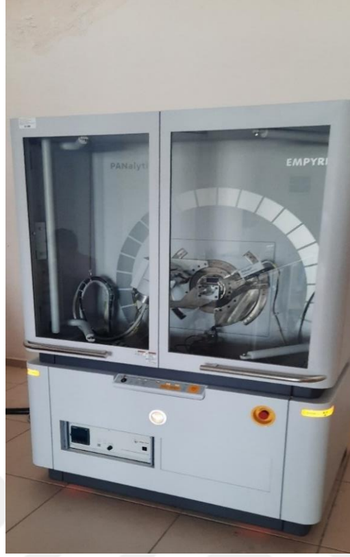
Şekil 4.23. Temel bilimler araştırma laboratuvarında bulunan 3. nesil malvern empyrean XRD cihazı
