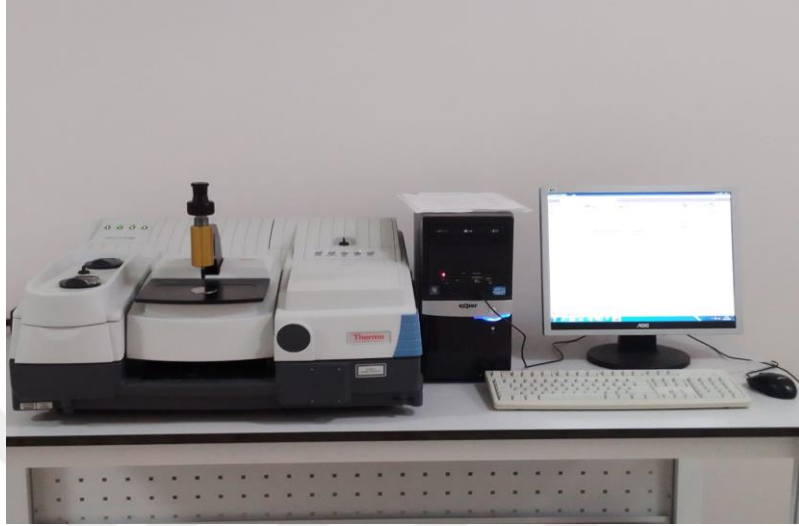
Şekil 4.24. Temel bilimler araştırma laboratuvarında bulunan Nicolet iS5 FT-IR spektrometre cihazı
