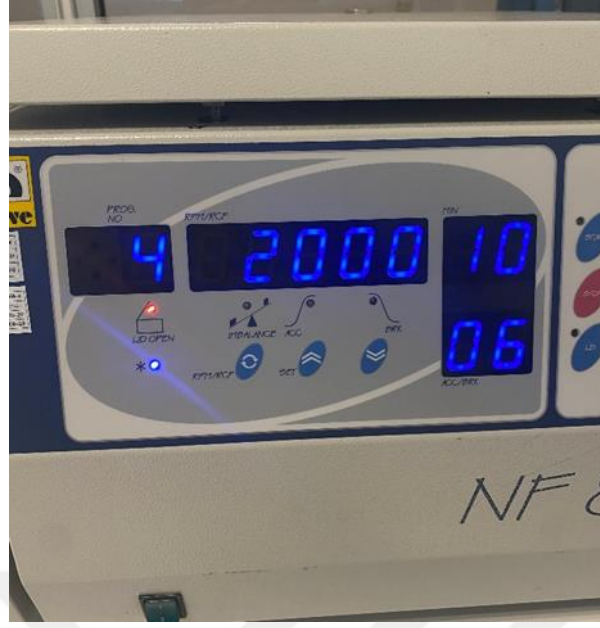
Şekil 2. Alınan Kan Örneklerinin 2000 Rpm’de 10 dk Santrifüj Edilmesi
