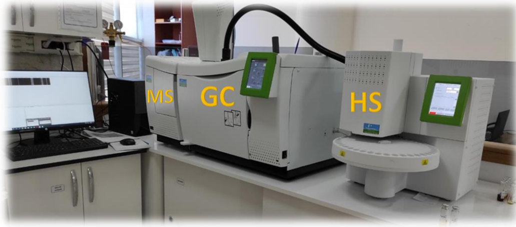
Şekil 36. Naftalin analizinin yapıldığı GC/MS/HS cihazı
