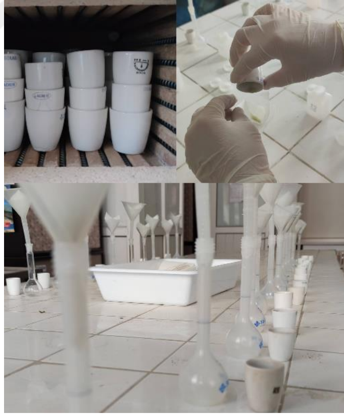
Şekil 3.9 Kül fırınında kül haline getirilen ve sonrasında balon jojelere konulan örnekler
