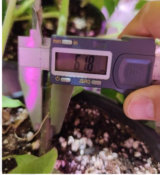
řekil 3.5 Gvde apının dijital kumpasla llmesi
