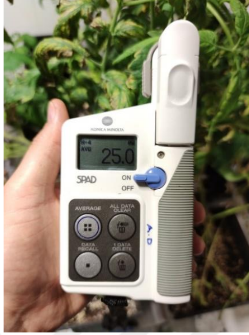
Şekil 3.6 Yaprak klorofil içeriğinin spadmetre cihazı ile ölçülmesi
