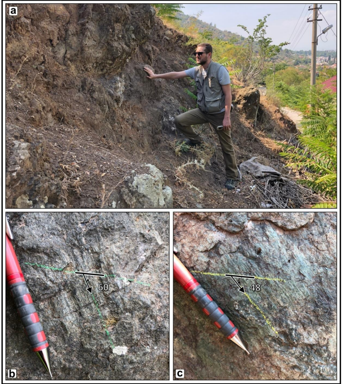
Şekil 3.5 a) Dere mahalle batısında yer alan serpanit bloğu yüzleği ve b-c)üzerindeki fay düzlemleri (Kişisel arşiv, 2020)
