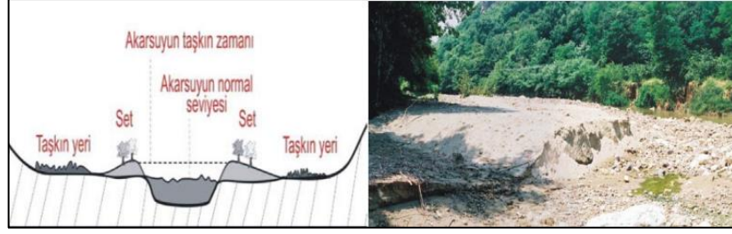
Şekil 2. Bir Akarsu Yatağının Kesiti ve Özgün Vaziyeti (Dölek, 2015)
