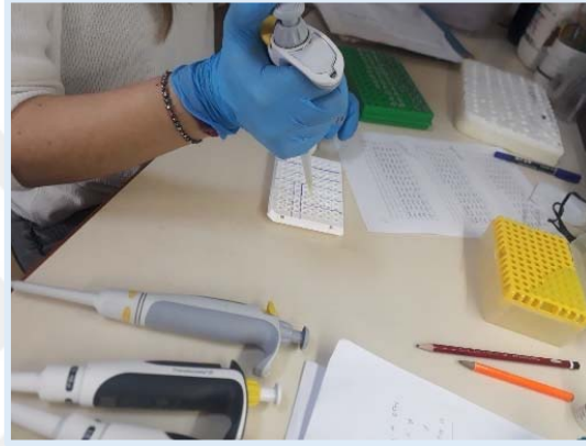
Şekil 3.22 RT-qPCR hazırlanırken SYBR Green qPCR master mix'in plate aktarılması
