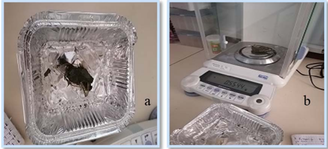
Şekil 3.13 Bitkilerin sürgün kuru ağırlığının belirlenmesi a) Sürgünlerin 60°C’de 48 saat kurutulması b) Sabit etüv ağırlığına ulaşmış sürgünlerin kuru ağırlıklarının hassas terazide belirlenmesi
