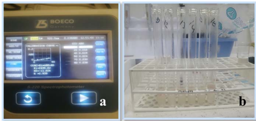
Şekil 3.20 a) Hıyar bitkilerinde prolin analizi için kaynayan örneklere toluen eklenmesiyle spektrofotometrede okunması b) L-prolin ile spektrofotometrede standardizasyonunun oluşturulması
