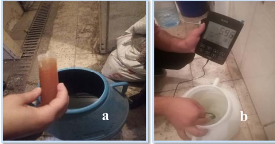
Şekil 3.2 Hidroponik ortam için a) Besin solüsyonlarının steril su içinde karıştırılarak hazırlanması b) Besin elementleri karıştırıldıktan sonra Ph 5,8'e ayarlanması
