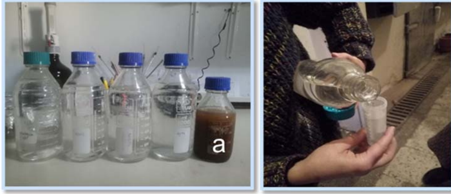
Şekil 3.1 Hidroponik ortam için hazırlanan a) Besin solüsyonları b) Besin solüsyonlarının ml biriminden ölçülmesi
