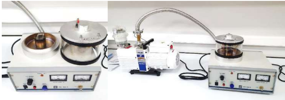
Şekil 4.2.2 Numune içerisindeki havanın arındırılması için vakumlanan ince kesit.
