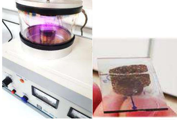
Şekil 4.2.3 Au ile kaplandıktan sonra çift taraflı karbon banda yapıştırılan ince kesit.
