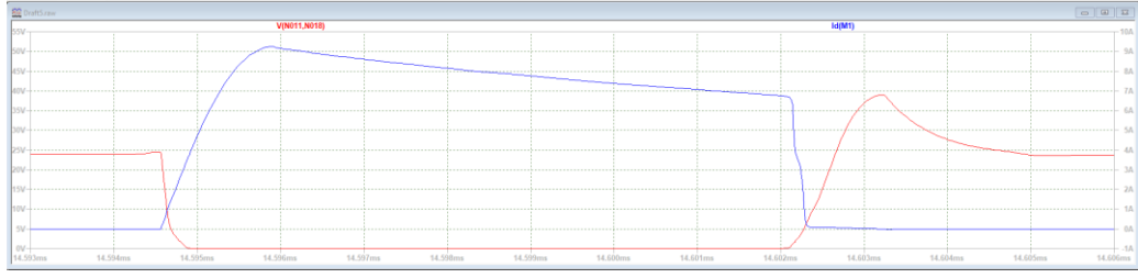
Şekil 4.2. LTspice simülasyon sonucu (kırmızı: gerilim, mavi: akım)
