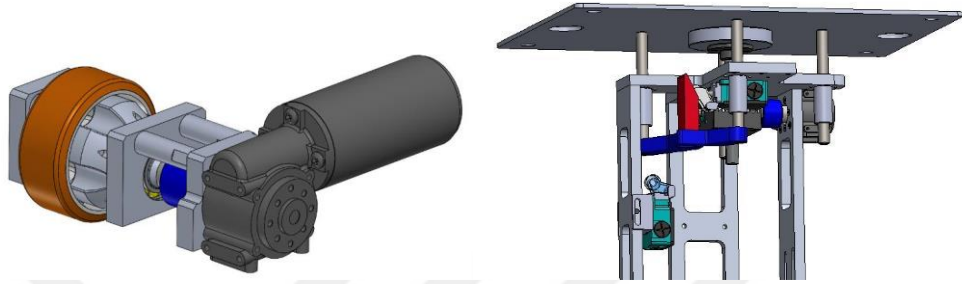
Şekil 3.4. Kaldırıcı tahrik sistemi ve hareket mekanizması tasarımı
