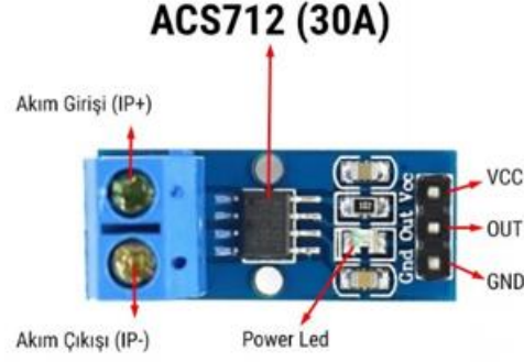
Şekil 3.13. ACS712 (30A) sensörü
