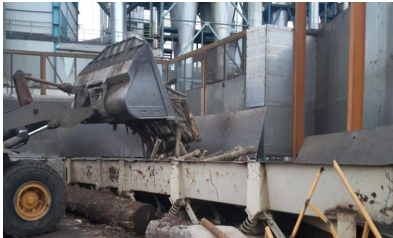
Şekil 2.14. Vibrasyonlu tekneye odun beslenmesi
