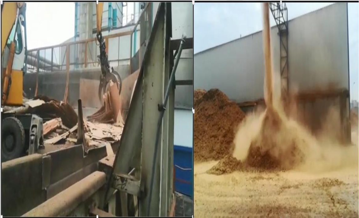
Şekil 3.2. Atık MDF levhaların yongalanması ve depolanması
