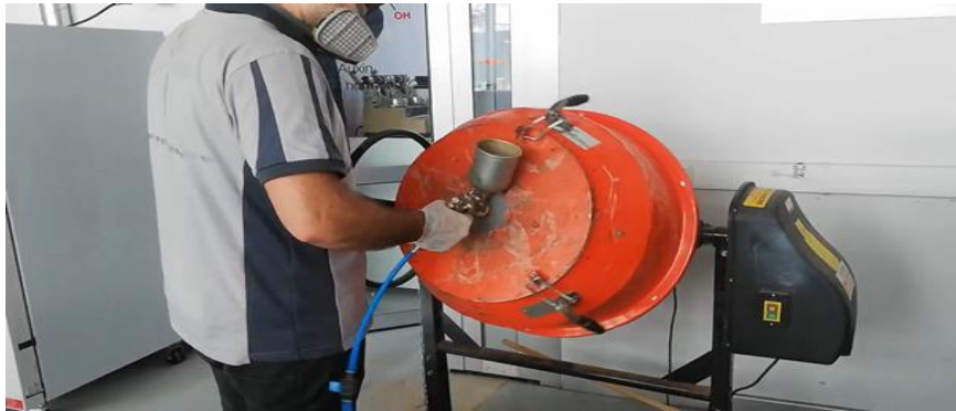
Şekil 3.3. Liflerin ligninle modifikasyonu ve liflerin tutkallanması
