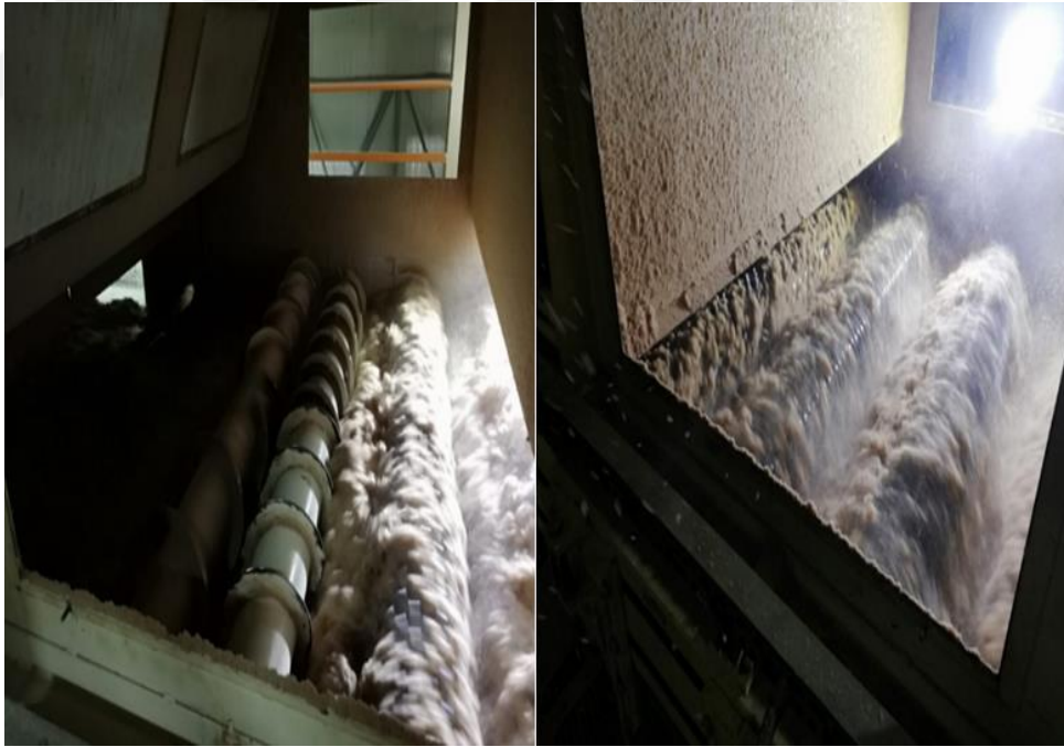
Şekil 2.30. Serme dağılım düzeltici sistem (Ekolayzır)
