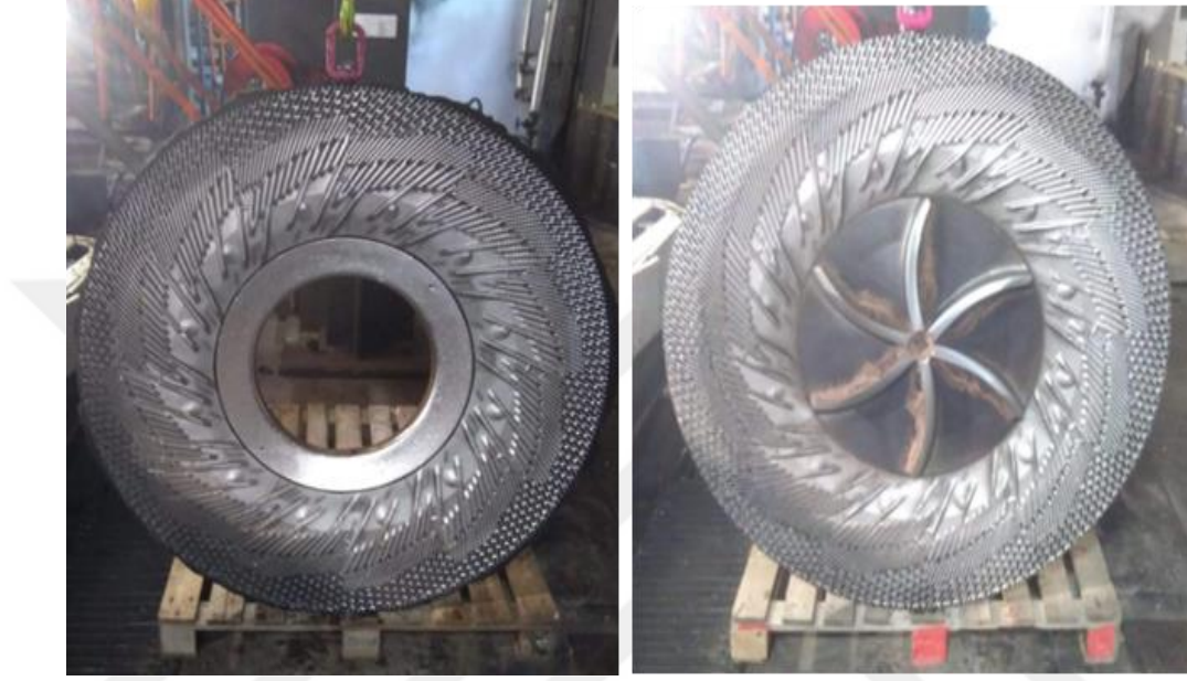
Şekil 2.24. Liflendirme makinası sabit ve hareketli bıçak resimleri (Rotor – Stator)
