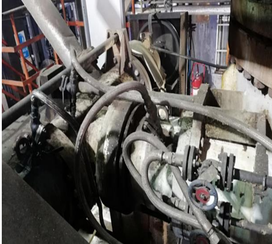
Şekil 2.22. Pişirme kazanı çıkışında parafin verilen enjektörler
