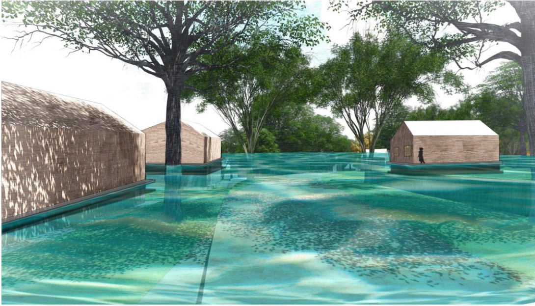
Şekil 4.23 : Varsayımsal bir kentsel ölçekte su seviyeleri 5 m yükseldiğinde Modül-A konutunun yükselmesi ile zeminden ayrılması, tahliye hazırlığı aşaması (Faz 3, pozisyon B” ‘de gösterildiği gibi).
