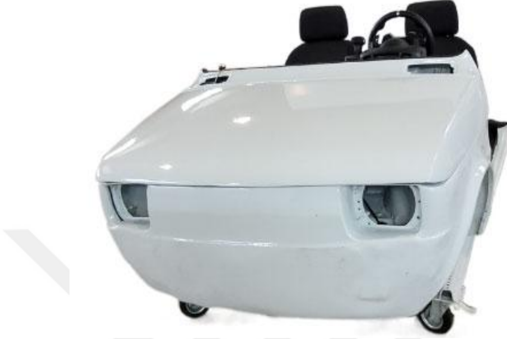
Şekil 3.1. Yarım Kesit A-segment otomobile ait test platformu
