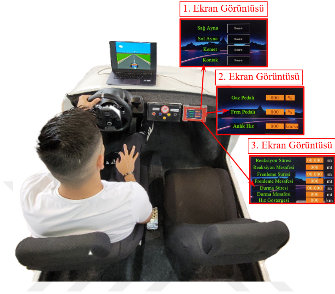
Şekil 3.14. Nihai sürüş simülöründe gerçekleştirilen örnek test sürüşü
