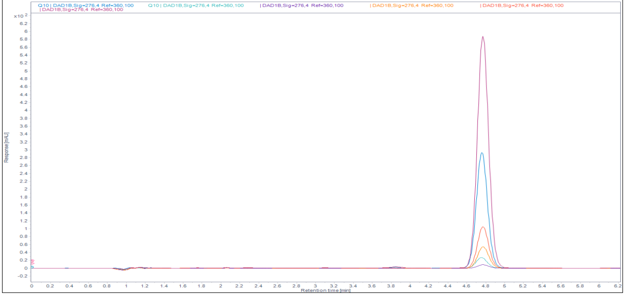
Şekil 4.3. Hareketli faz ortamında bulunan koenzim Q10'un standart doğrusunda bulunan seviyelerin üst üste çakıştırılmış HPLC kromatogramları
