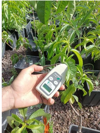
Şekil 3.3 Demir testlemesi yapılan şeftali melezlerinde FluorPen FP100 fluorometresi ile fotosistem II (PSII) ölçümü
