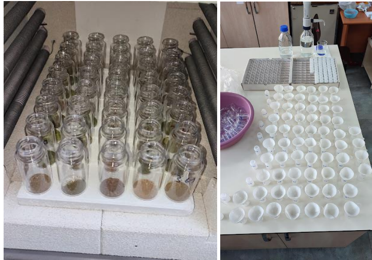
Şekil 3.5 Kuraklık testlemeleri Zn ve Cu analizleri için kül fırınına yerleştirilen örnekler (solda), süzük alma işlemi için hazırlık (sağda)
