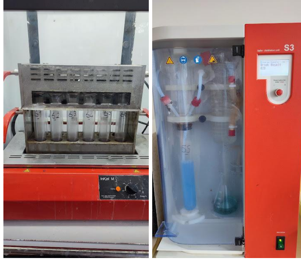
Şekil 3.4 Kuraklık testlemelerinde azot analizi için örneklerin yakılması (solda) ve destilasyonu (sağda)
