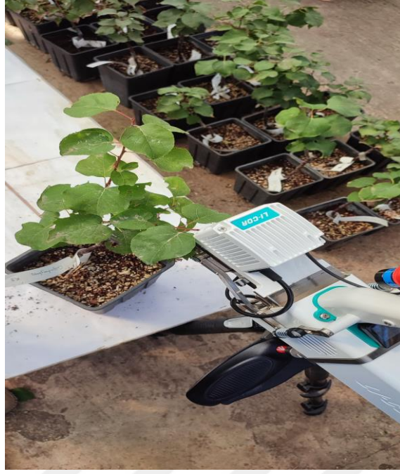
Şekil 3.2 Kuraklık testlemesi yapılan kayısı çeşit ve genotiplerinde Li-Cor LI-6800 model taşınabilir fotosentez ölçüm cihazı ile fotosentez parametreleri ölçümü
