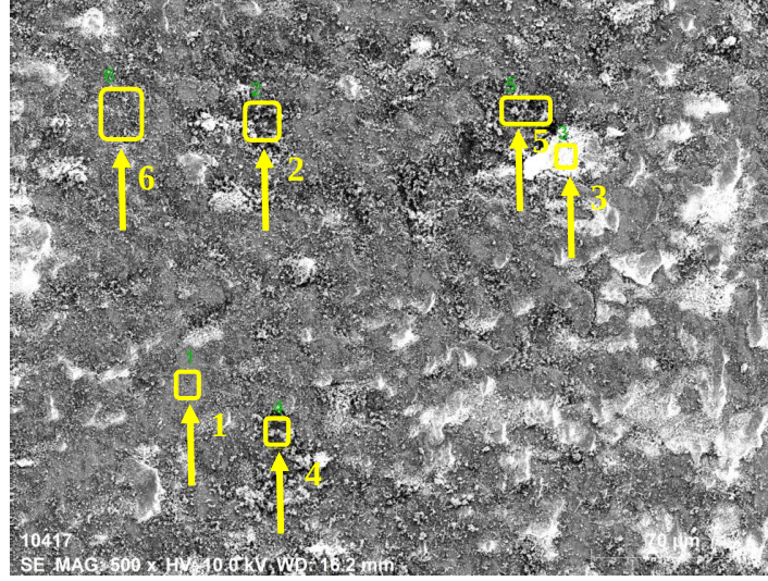
Şekil 4.18. YEA-2 Alaşımının 20N Yük Altında EDX Analizi.
