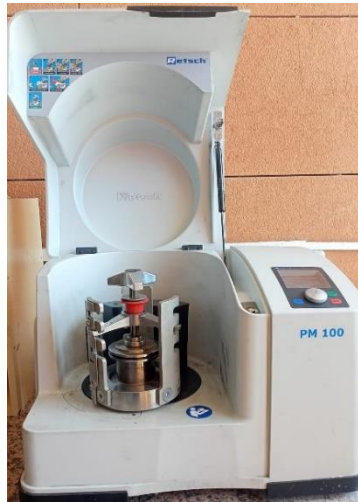
Şekil 3.4 Karıştırma işleminde kullanılan yüksek enerjili bilyeli öğütücü
