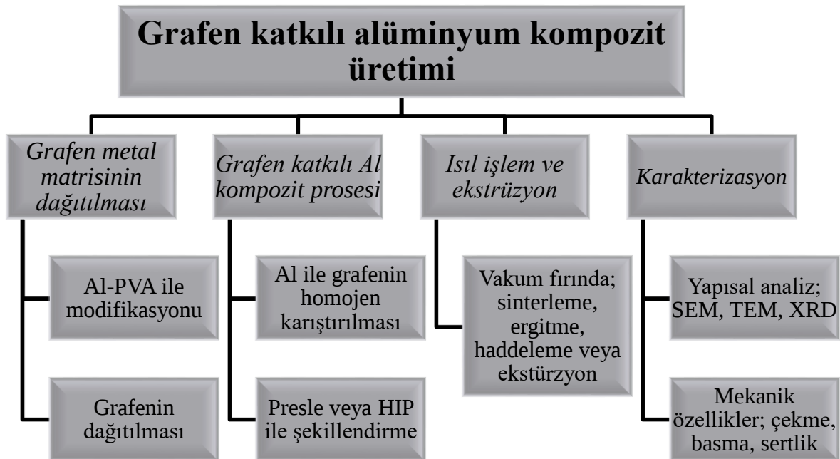
Şekil 3.8. Grafen takviyeli Al kompozitlerin üretim şeması
