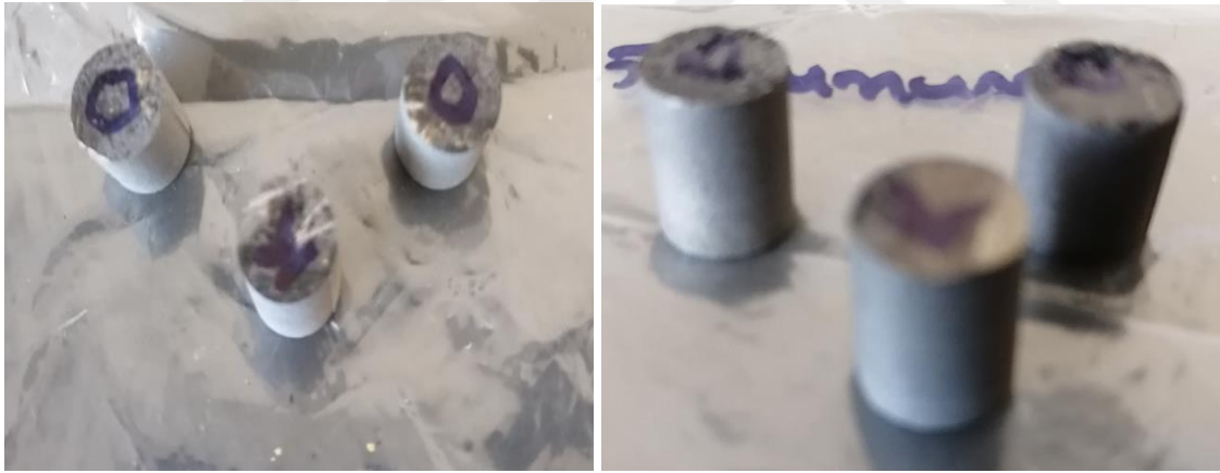
Resim 4.12. Aşınma testi numuneleri
