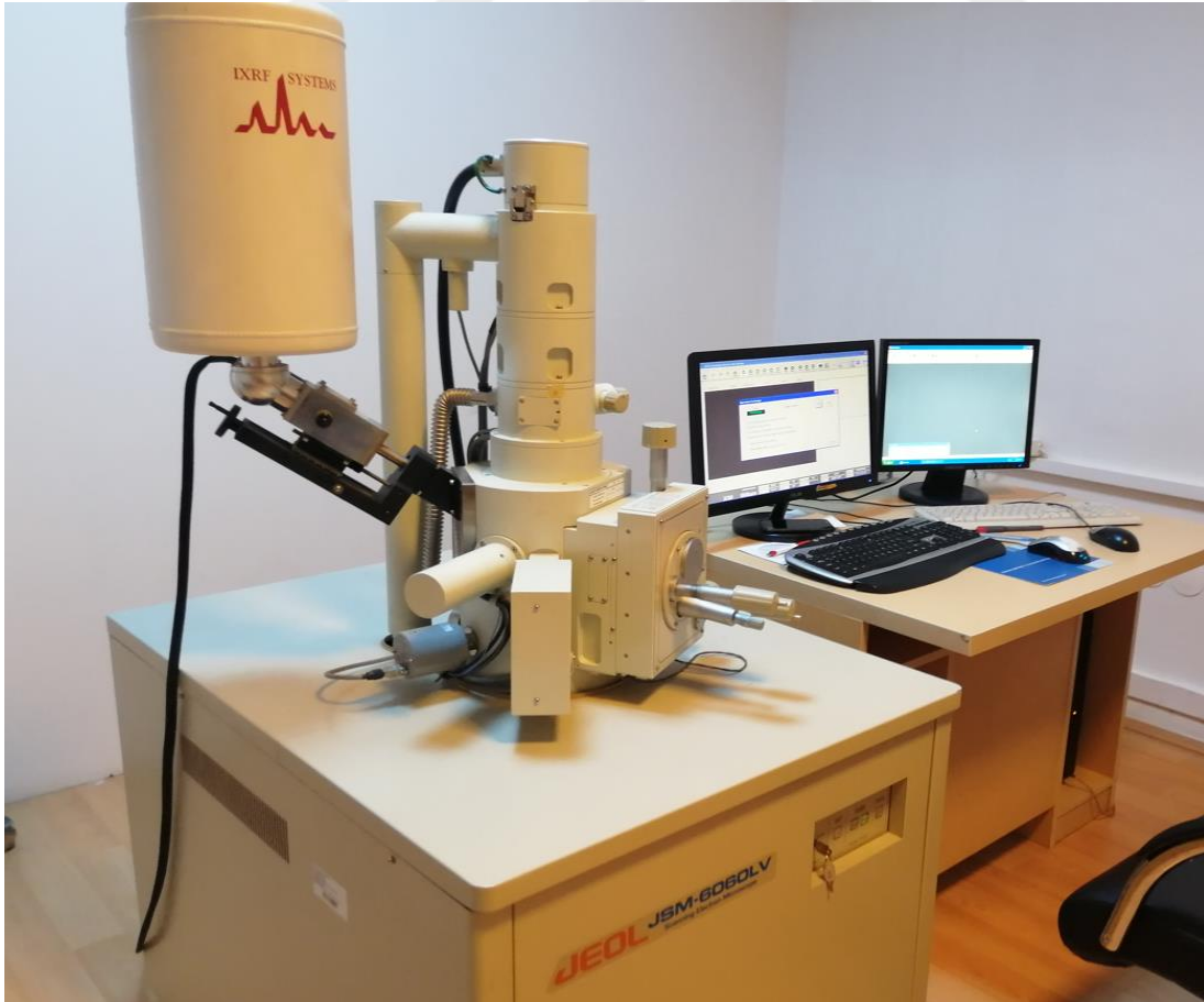
Resim 4.9. JEOL JSM 6060LV taramalı elektron mikroskobu
