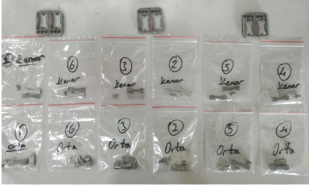
Resim 4.5. Tel erozyon sonrası numunelerin gösterimi
