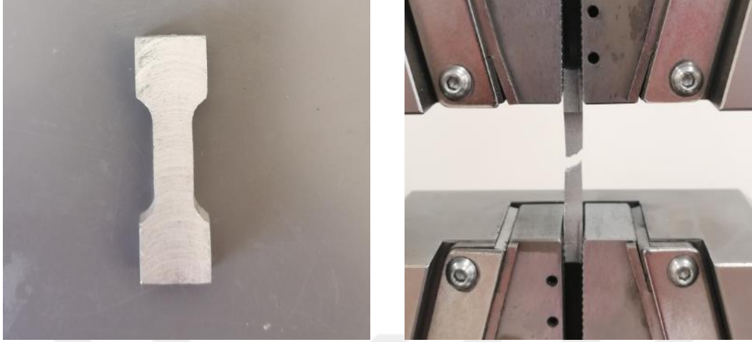
Resim 5.3. Çekme testi numunesi öncesi ve sonrası
