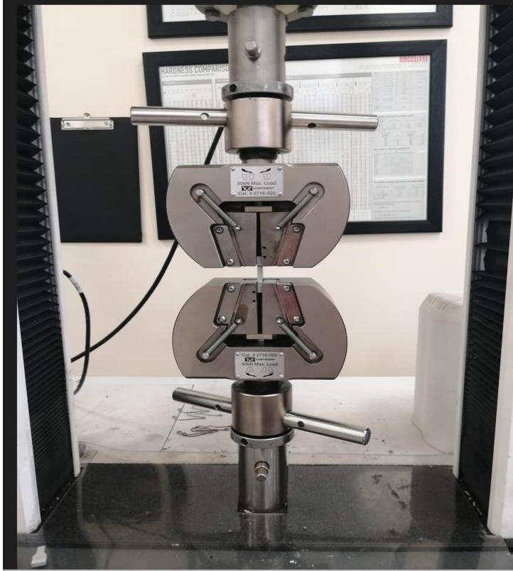
Resim 4.11. Instron 3369 model 50 kN kapasite test cihazı
