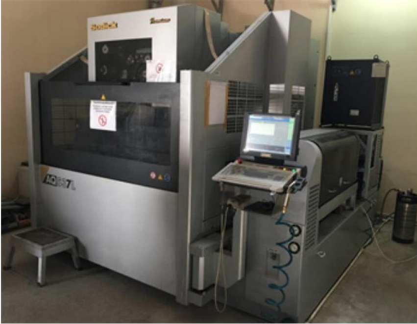
Resim 4.4. Sodick tel erozyon tezgahı (Atılım Üniversitesi)
