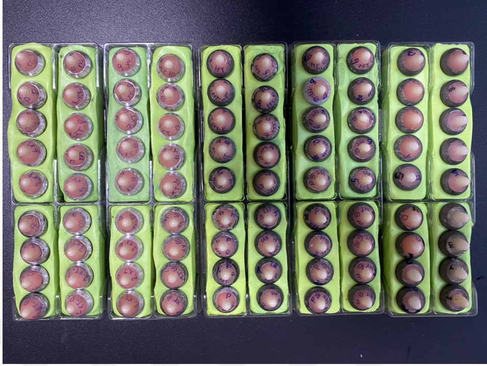
Resim 4. Hazırlanmış feldspatik porselen ve monolitik zirkonya örnekler
