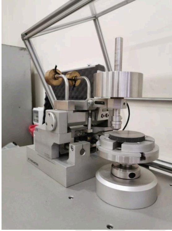
Resim 8.1. Aşınma deneylerinde kullanılan ASTM G99-05 UTS 10/20 model tribometre
