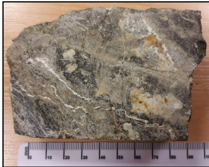
Şekil 2.13: Çalışma Alanındaki Petrografik İncelemesi Amfibolitlere Ait Karotun Makroskobik Fotoğrafı (KAS13 sondajı 19,90 – 20,00 m aralığı)
