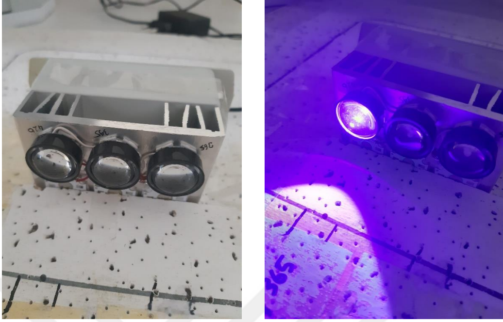
Şekil 4.6 CO Salınımı İçin Kullanılan UV Lamba Düzeneği
