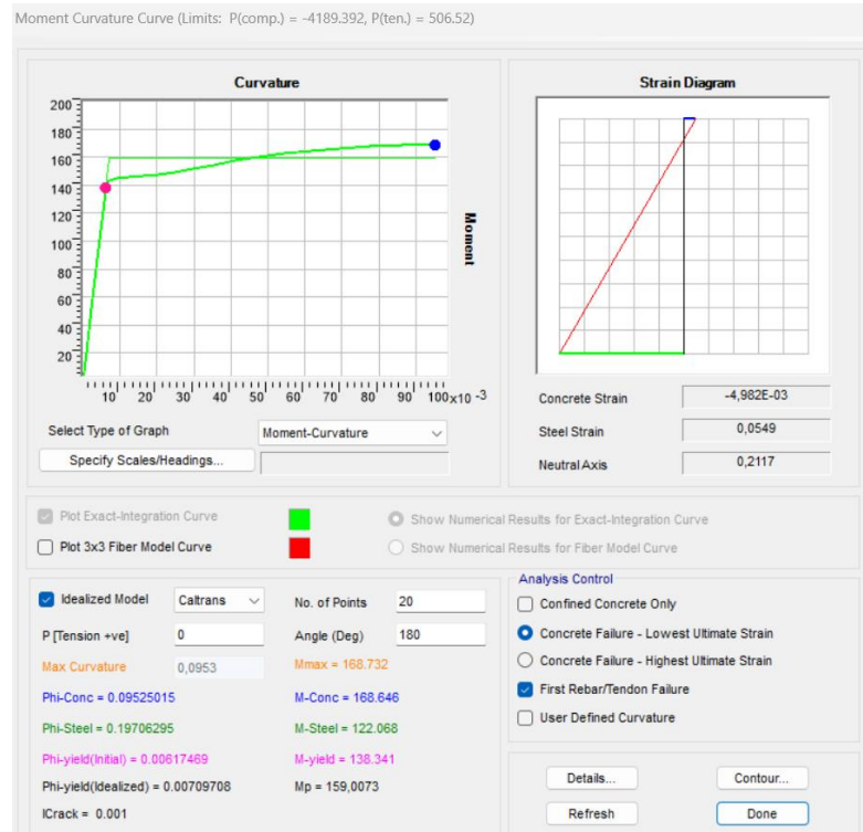
Şekil 82. 10 katlı yapının kiriş modeline ait moment-eğrilik analizi ( \Theta=0 )
