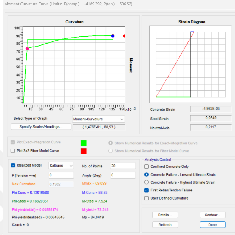
Şekil 82. 10 katlı yapının kiriş modeline ait moment-eğrilik analizi ( \Theta=0 )
