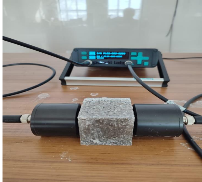
řekil 3.14. Polimer beton numuneleri ultra ses geçiř hızı testi ve deney cihazı
