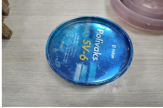
Şekil 3.6. Numuneleri kalıptan ayırmak için kullanılan kalıp ayıcı vaks
