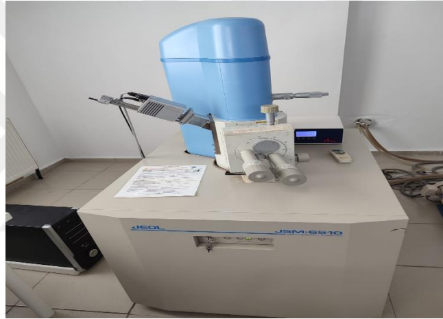
Şekil 3.15. SEM görüntüleme analizi ve deney cihazı
