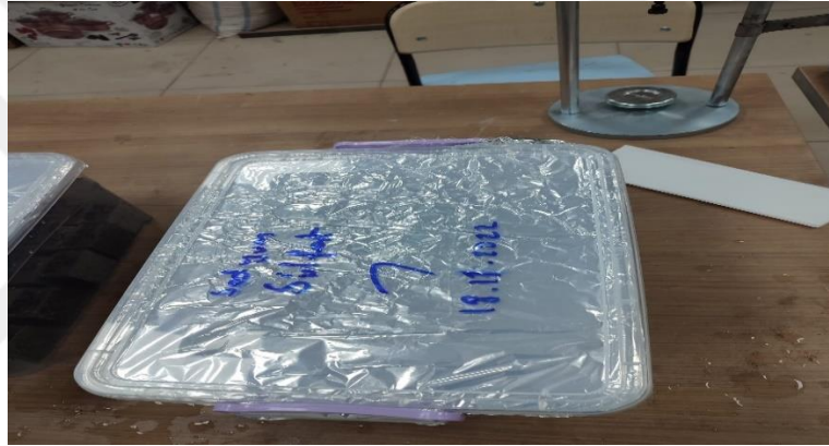
Şekil 3.2. Sodyum sülfat çözeltisine maruz bırakılan numunelerin muhafazası
