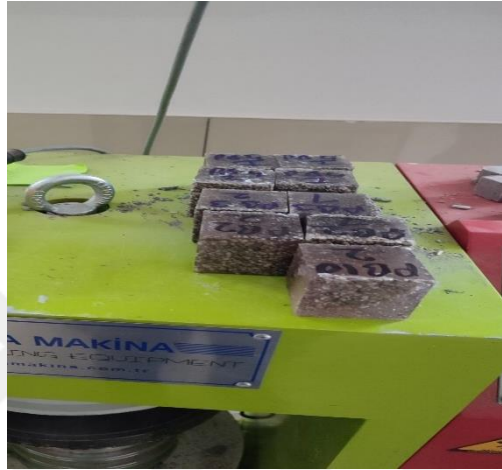
Şekil 4.2. Basınç dayanımına tabi tutulan polimer beton numuneleri
