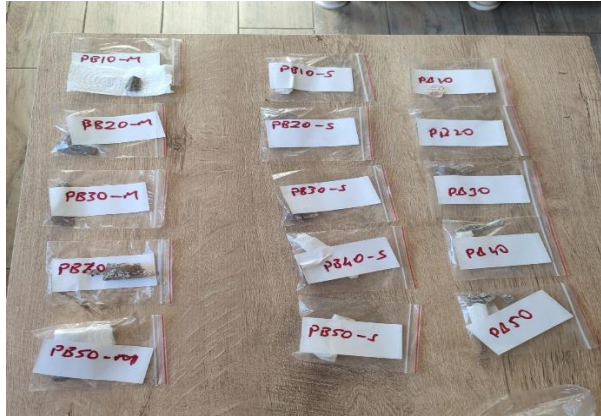
Şekil 3.18. Polimer beton numunelerinden alınan küçük parçalar
