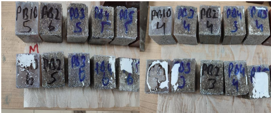
Şekil 4.4. Basınç deneyine tabi tutulan sodyum sülfat ve magnezyum sülfata maruz bırakılan numuneler
