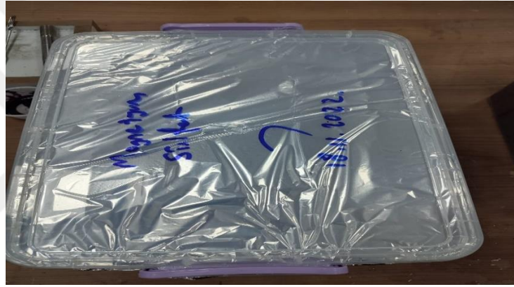
Şekil 3.3. Magnezyum sülfat çözeltisine maruz bırakılan numunelerin muhafazası
