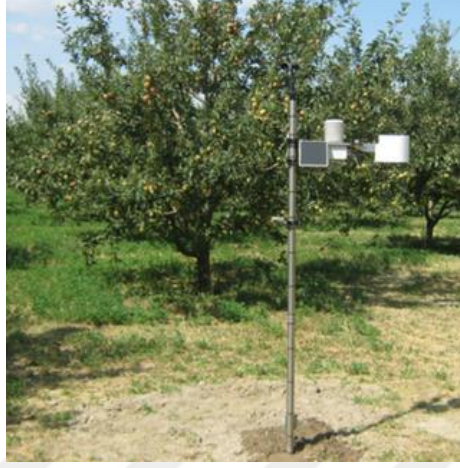
Şekil 3: Bilgisayar destekli elektronik tahmin ve uyarı cihazı (TOB 2, 2023)
