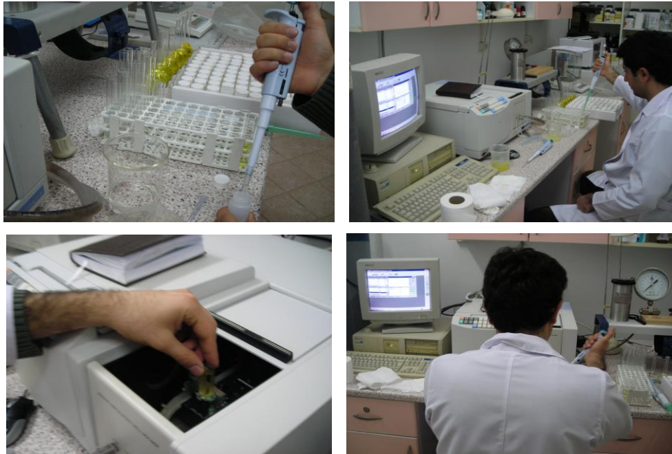
Şekil 3.22. Marul yapraklarında C vitamini, nitrat analizleri ve fosfor tayini için yapılan spektrofotometre cihazı
