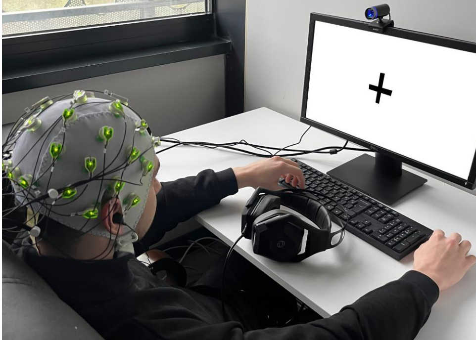
Şekil 8. Deney düzeneği: EEG başlığı, kulak içi kulaklık, klavye ve monitör
