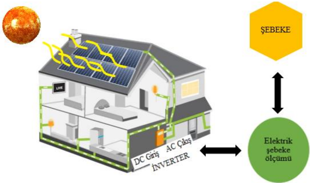
Şekil 2.4: Güneş enerjisi üretim akım şeması.
