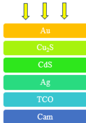
Şekil 2.17: N-CdS/P-Cu 2 S Pillerinin şematik kesit görünümü.
