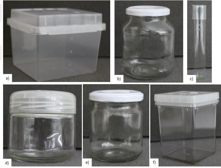
Şekil 3.3. Çalışmada kullanılan kültür kapları. a) Vetrovent (12x11x9,5 cm), b) 300 mL'lik kavanoz (8x6,5x10 cm), c) Cam tüp (2x2x14,5 cm), d) 265 mL'lik kavanoz (8x8x8,4 cm), e) 170 mL'lik kavanoz (6,4x6,4x7,6 cm), f) Magenta (7,4x7,4x9,6 cm).
