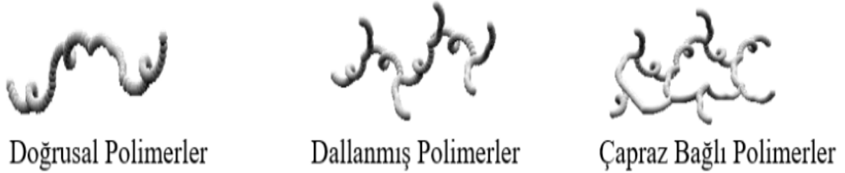
Şekil 17. Zincir şekillerine göre polimerlerin sınıflandırılması
