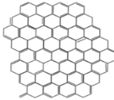
Şekil 11. Grafenin bal peteği yapısının şematik görünümü
