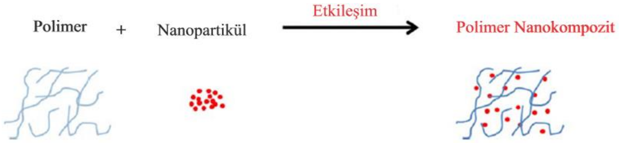
Şekil 18. Polimer nanokompozitlerin oluşumu
