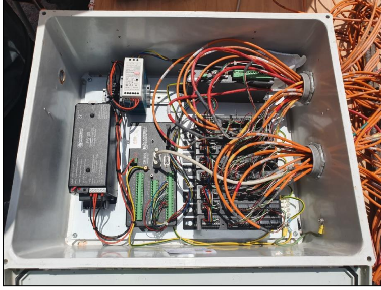
Şekil 5. 33 Çok kanallı veri toplama sistemi (data logger)
