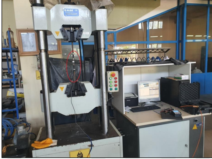
Şekil 5. 10 Strain gauge doğrulama testi yapılışı
