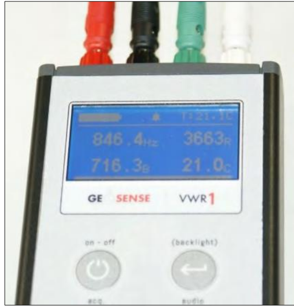
Şekil 5. 32 Tek kanallı veri toplama sistemi
