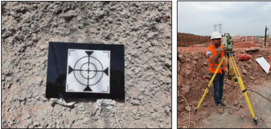
Şekil 5. 34 (a) Reflektörler ve (b) Topoğrafik ölçüm yapılması
