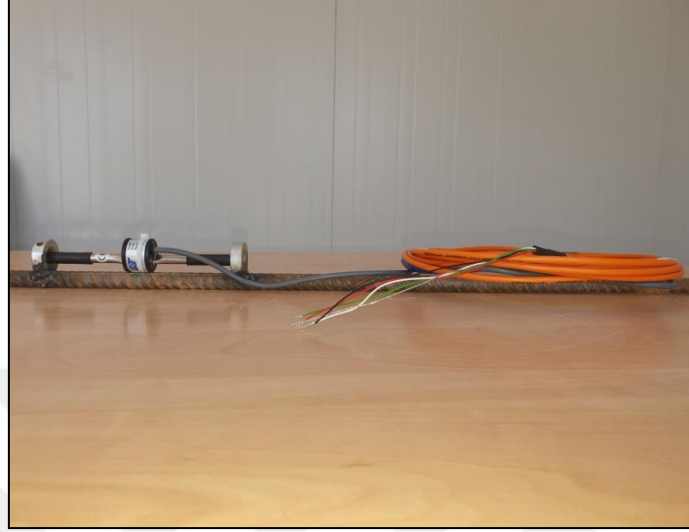
Şekil 5. 8 Zemin çivisi üzerinde kaynaklı strain gauge düzeneği
