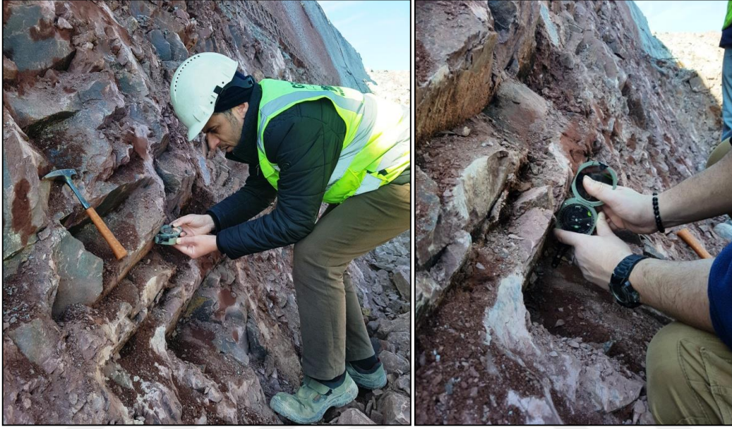
Şekil 4. 27 Model aynasında tabaka eğim ve doğrultu ölçümü
