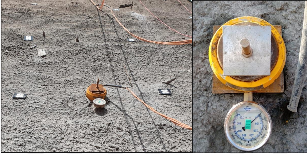
Şekil 5. 35 Çivi kafasına yerleştirilen yük hücresi (Load Cell)
