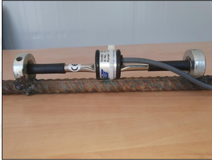
Şekil 5. 31 Çiviye kaynaklı gerinim ölçer (Strain Gauge)
