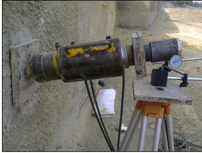
Şekil 5. 6 Çivi çekme deneyi düzeneği [145]
