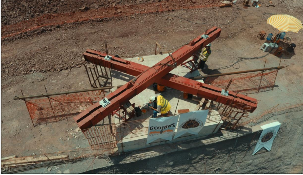
Şekil 5. 26 Yükleme deneyi düzeneği
