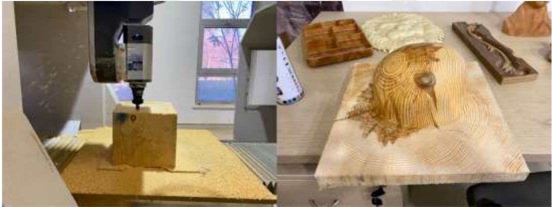
Görsel 10. Kask Kalıbının Yapım Aşamaları
