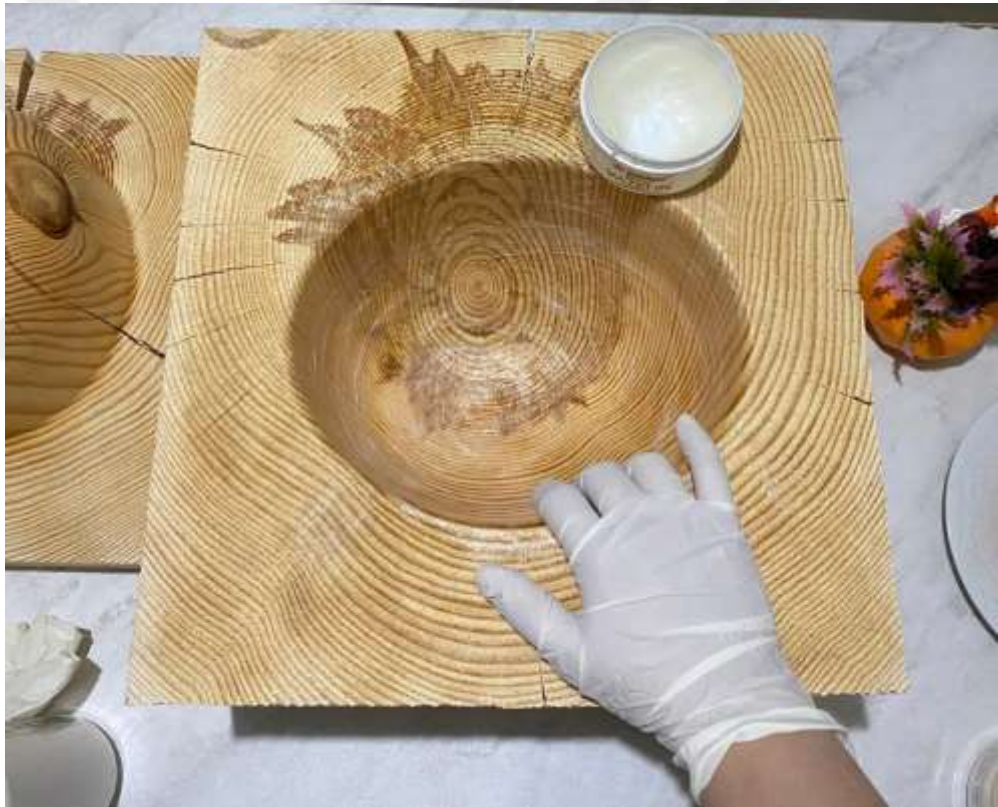
Görsel 11. Kask Prototipine Vazelin Sürülmesi
