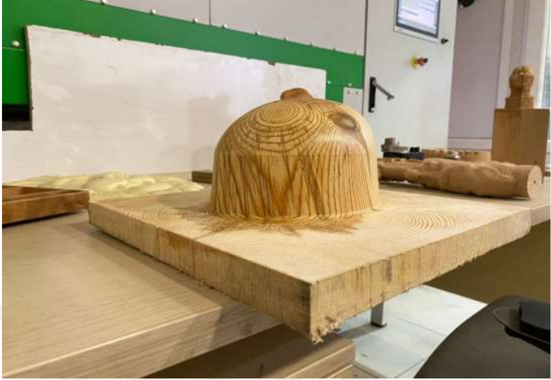
Görsel 9. Kaskın Dış Katmanını Sıkıştırmak İçin Üretilen Kalıp
