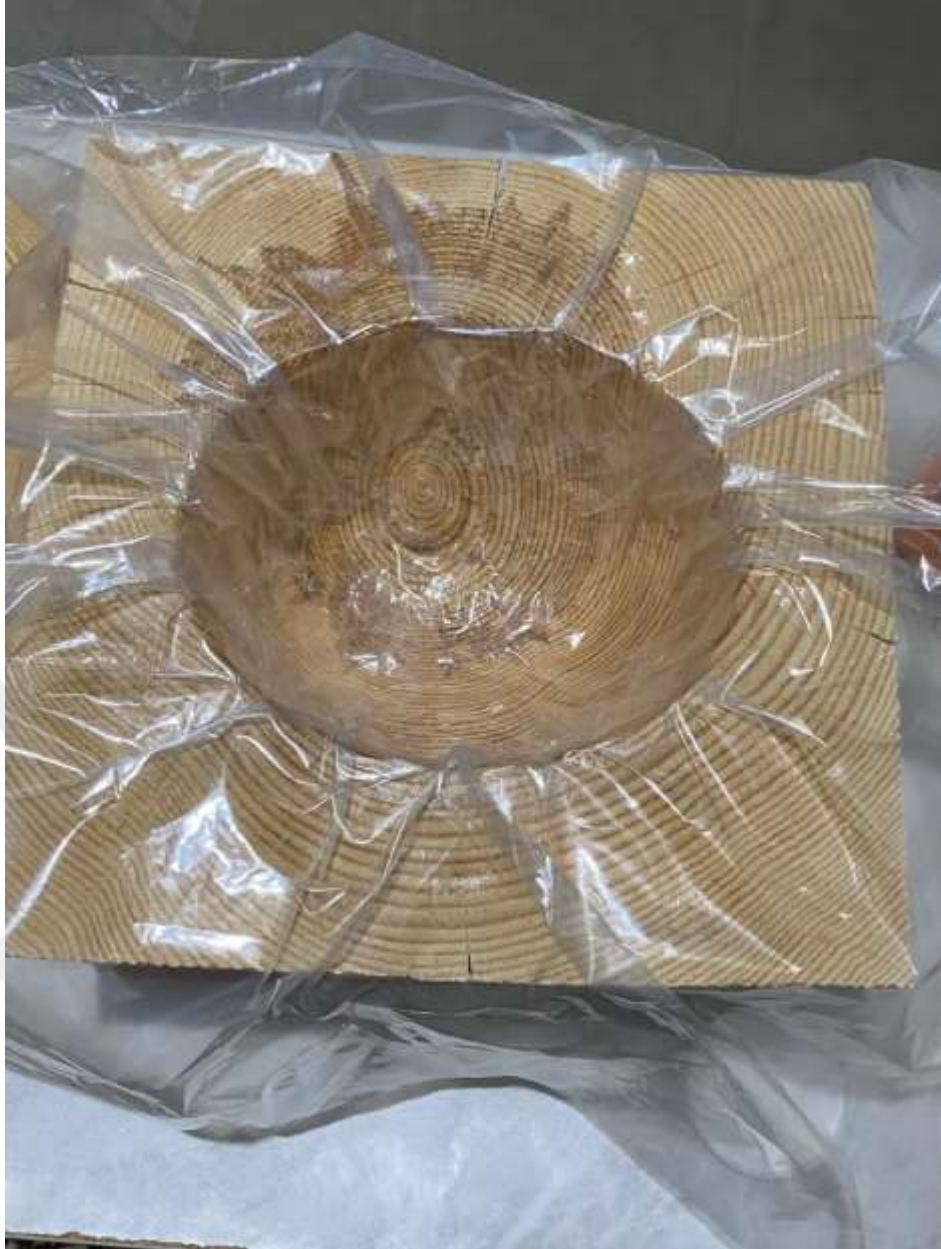
Görsel 12. Kask Prototipine Şeffaf Naylon Poşetin Yerleştirilmesi
