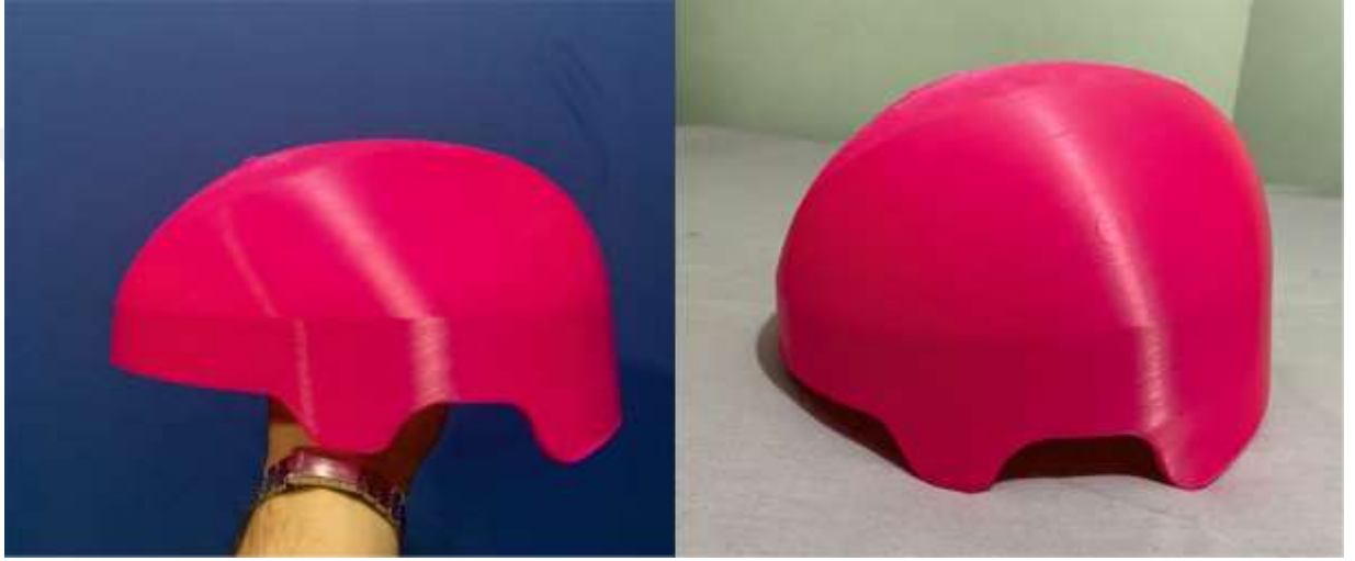
Görsel 7. 3D Kask Prototipi
