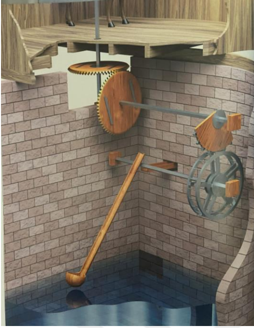
Şekil 5.10. Tek kepçeli su yükseltme düzeneği çalışma modeli (Çalışkan, 2019)
