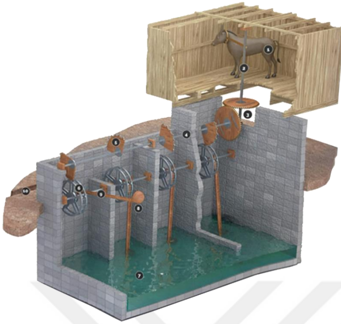
Şekil 5.12. Dört kepçeli su yükseltme düzeneği çalışma modeli (Çalışkan, 2019)
